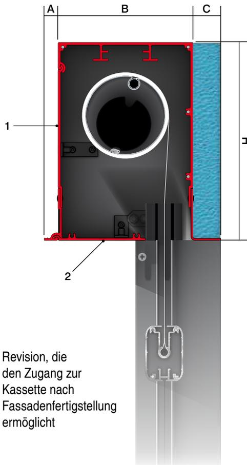
2 - Revision, die den Zugang zur Kassette nach Fassadenfertigstellung ermöglicht
